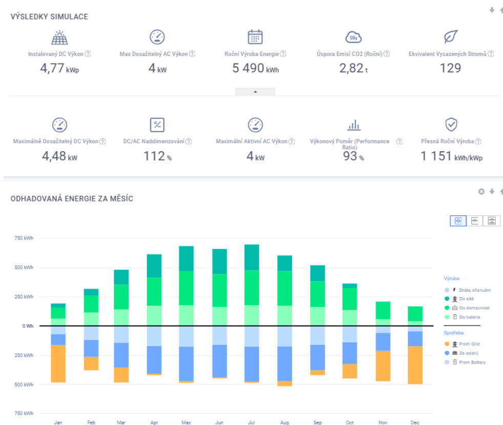
Obrázek 28 Modelová výroba FVE na střeše objektu ČOV
